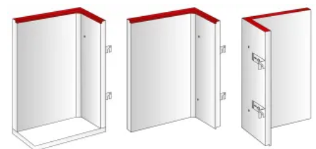
Beton-Lichtschächte als einschenklig Variante
