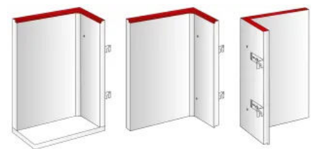
Beton-Lichtschächte als einschenklig Variante
