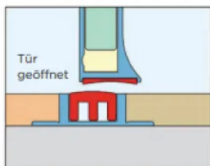
Magnet ist unten, der Durchgang bleibt absolut barrierefrei
