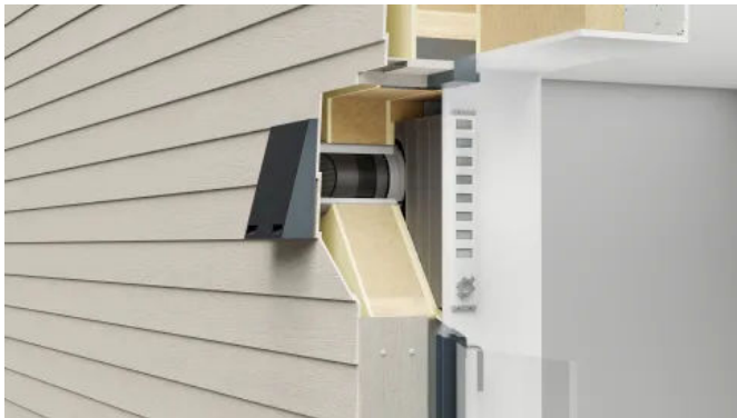
iV-Zero Prefab im Schnitt
