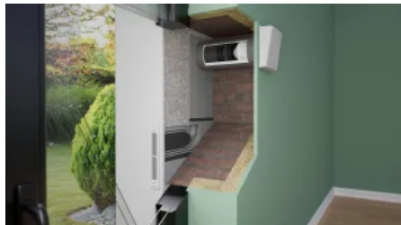
Corner-Außenabschluss in der Fensterlaibung
