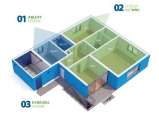
Bei kombinierten Systemen kommen mindestens zwei verschiedene Lüftungsarten gemeinsam zur Anwendung. Besonders effektiv arbeiten Kombinationen von Abluftgeräten und Lüftern mit Wärmerückgewinnung: Während die Wohnräume dank Wärmerückgewinnungsgeräten über konstant frische Luft ohne Wärmeverluste verfügen, können klassische Ablufträume wie Bad, WC, Küche oder HWR kosteneffizient bei Bedarf entlüftet werden. Bei fensterlosen Bädern und WCs ist ein Abluftgerät nach DIN 18017-3 vorgeschrieben.
