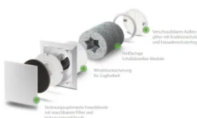
Außenwand-Luftdurchlass ALD: für alle Anwendungen, insbesondere für den Einsatz in Wohn- und Schlafräumen
