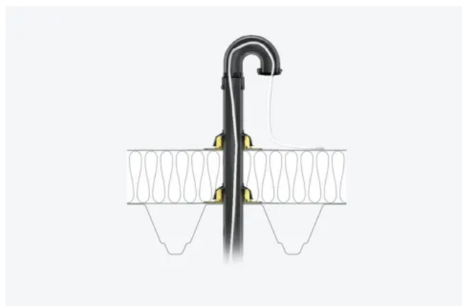
C. Eingebaut in einem nicht belüfteten Dachaufbau: SitaVent Rohrdurchführung
