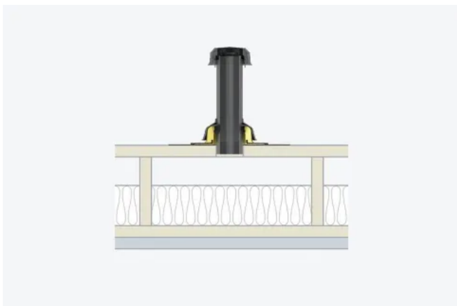
B. Eingebaut in einem belüfteten Dachaufbau: SitaVent Kaldachlüfter
