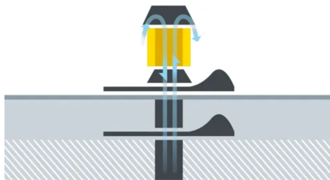
Kondensabweisender Anschluss. Vermindert Eindringen von Kondenswasser.
