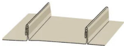
Beispiel Verkleidung mit Stehfalssystem
