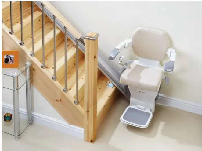
Die klappbare Schiene des Handicare 1000 wird direkt auf den Stufen montiert und enthält je einen Ladeplatz oben und unten für den 24V Akkubetrieb.
