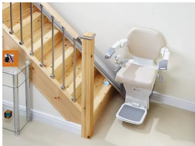
Die klappbare Schiene des Handicare 1000 wird direkt auf den Stufen montiert und enthält je einen Ladepunkt oben und unten für den 24V Akkubetrieb.
