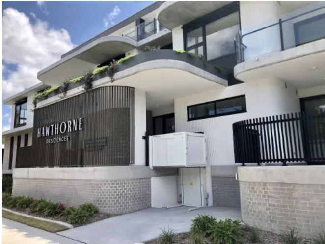
Der Savaria Multilift ist ein witterungsbeständiger Hublift ohne Schacht.
