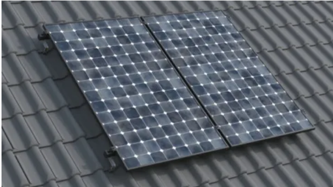
Photovoltaik Magic PV Pitch Schrägdachanlagen werden mithilfe von Dachhaken, Montageschienen und Modulklemmen direkt an den Dachsparren befestigt.
