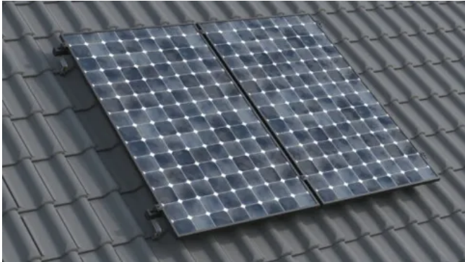
Photovoltaik Magic PV Pitch Schrägdachanlagen werden mithilfe von Dachhaken, Montageschienen und Modulklemmen direkt an den Dachsparren befestigt.
