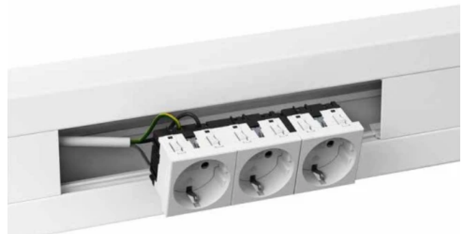
Die Montage der Modul 45 Einbaugeräte erfolgt werkzeuglos durch Rastbefestigung und integrierte Steckklemmen.
