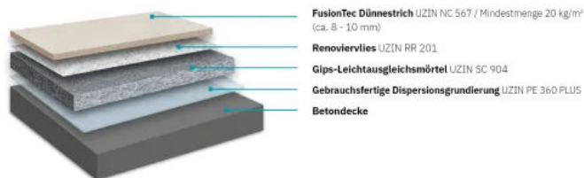
UZIN Turbolight®-System CA auf Betonuntergründen
