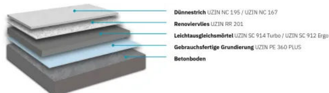
UZIN Turbolight®-System auf Betonuntergründen
