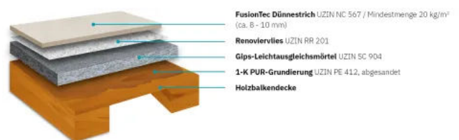
UZIN Turbolight®-System CA auf Holzbalkendecken
