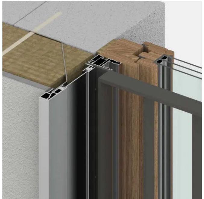
Konstruktionsdetail Zargensystem COVER in Kombination mit Glas-Absturzsicherung
