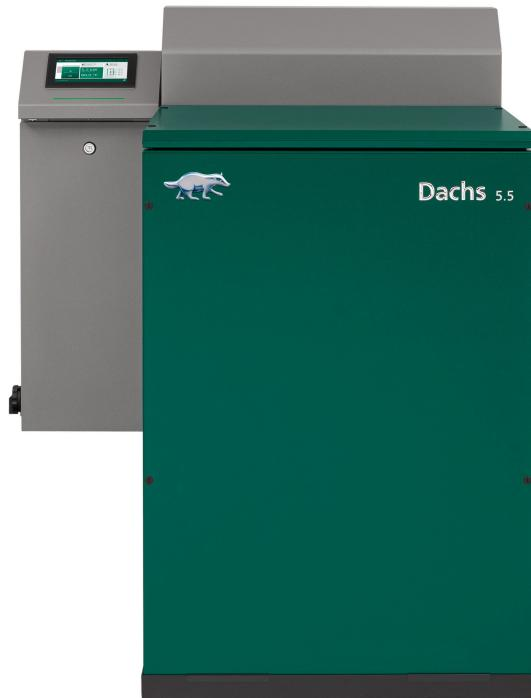
Das Gas-Blockheizkraftwerk Dachs 5.5 ist der weiterentwickelte Klassiker im SenerTec Sortiment. Das mit Erd- oder Flüssiggas betriebene Kraftwerk erzeugt bis zu 5,5 kW Strom und 14,8 kW Wärme und ist besonders für den Einsatz in Gewerbebetrieben, wie Hotels, Autohäuser, Pflegeheime, usw., oder Mehrfamilienhäusern geeignet.
