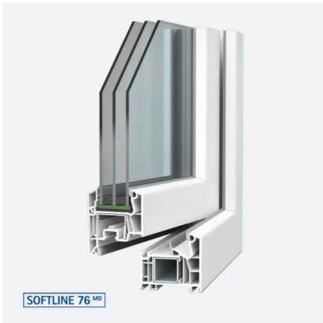
SOFTLINE 76MD mit Mitteldichtung ist ein Mehrkammer-System mit 76 mm Bautiefe und 3 Dichtungsebenen.
