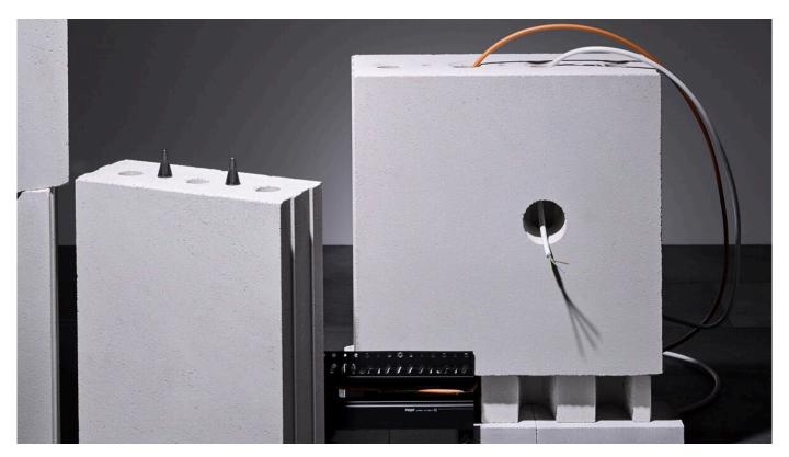
KS-QUADRO THERM und KS-QUADRO ETRONIC integrieren die Funktionen Heizung, Kühlung und Elektroverteilung in massives Mauerwerk aus Kalksandstein. Die KS-Rasterelemente verfügen über Lochkanäle im Abstand von 12,5 cm für die Installation von Wandtemperierungsmodulen (KS-QUADRO THERM) sowie zur schnellen und zerstörungsfreien Installation von Elektro- und Kommunikationsleitungen (KS-QUADRO ETRONIC).
