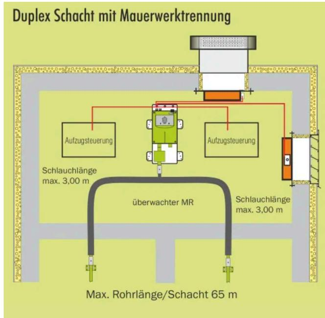
Einbauschema Duplexschacht mit Mauerwerktrennung
