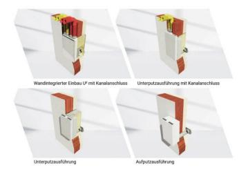
Einbauvarianten M-WRG-II-Komfortlüftung | @Meltem
