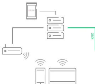
Als Client-Lösung mit externem Server & IP-Router
