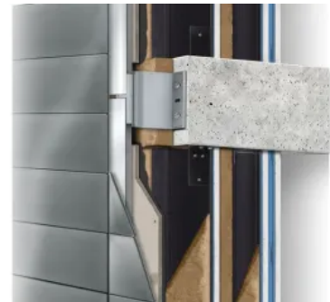
Doppelständerkonstruktion + VHF (WM412C.de)
