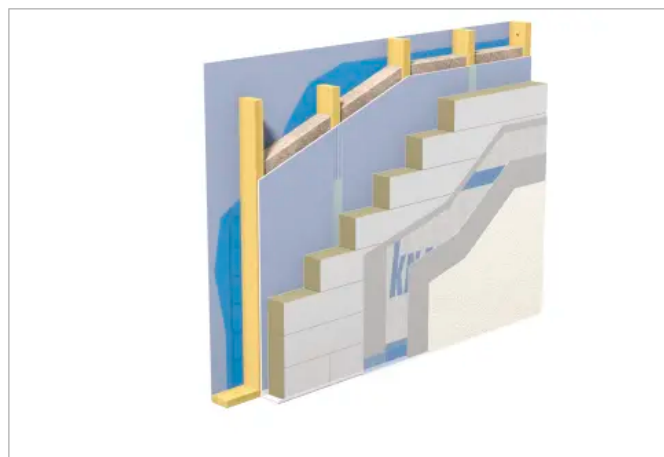
WARM-WAND Plus – Systemaufbau Holzbau
