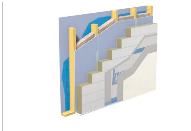
WARM-WAND Plus – Systemaufbau Holzbau
