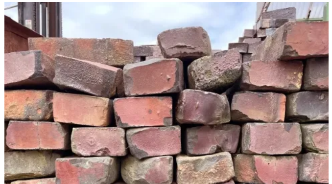
Durch eine gezielte Sortierung fügen sich die Pflasterklinker zu einem homogenen Gesamtbild zusammen.
