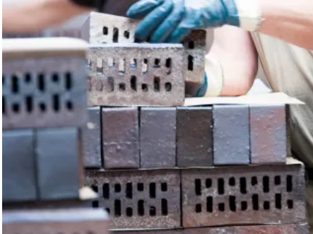
Wittmunder Klinker werden traditionell stranggepresst und handsortiert.
