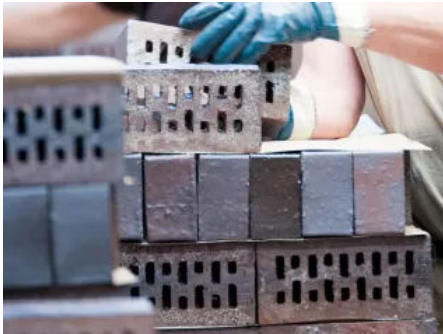
Wittmunder Klinker werden traditionell stranggepresst und handsortiert.
