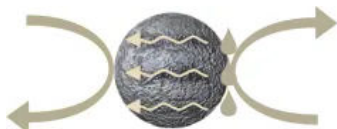
Geringer Wasserdampfdiffusionswiderstand, vermeidet Feuchteschäden
