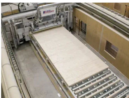
Fertigung der einzelnen Wand-, Boden- und Deckenelemente
