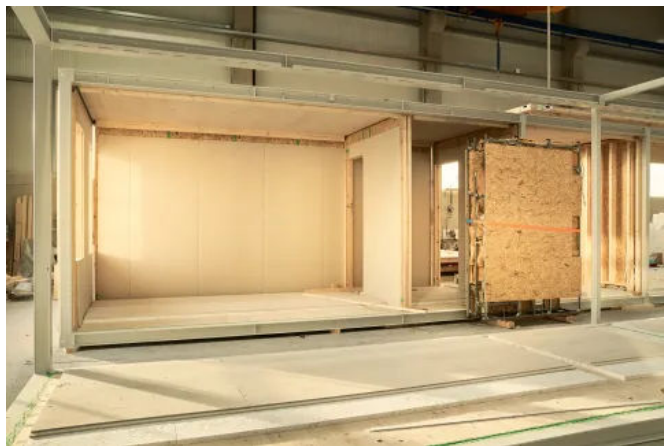
Vorfertigung der Holz-Hybrid-Module im Werk
