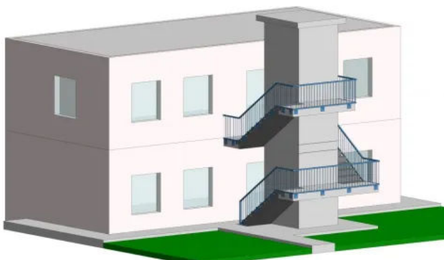
Aufzug frontal vorgesetzt mit Fluchttreppen
