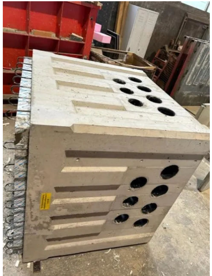
Die Kabelzugschächte werden komplett im Werk vorgefertigt und durch eigene LKW zur Baustelle transportiert.
