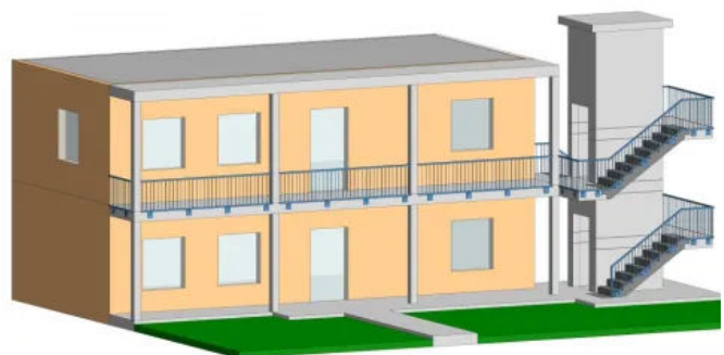
Aufzug seitlich angeordnet mit Fluchttreppen
