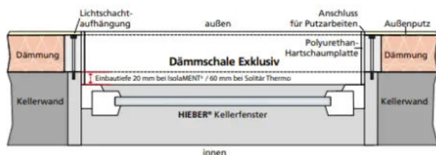
Einbauschema Thermo-Dämmschale Exklusiv
