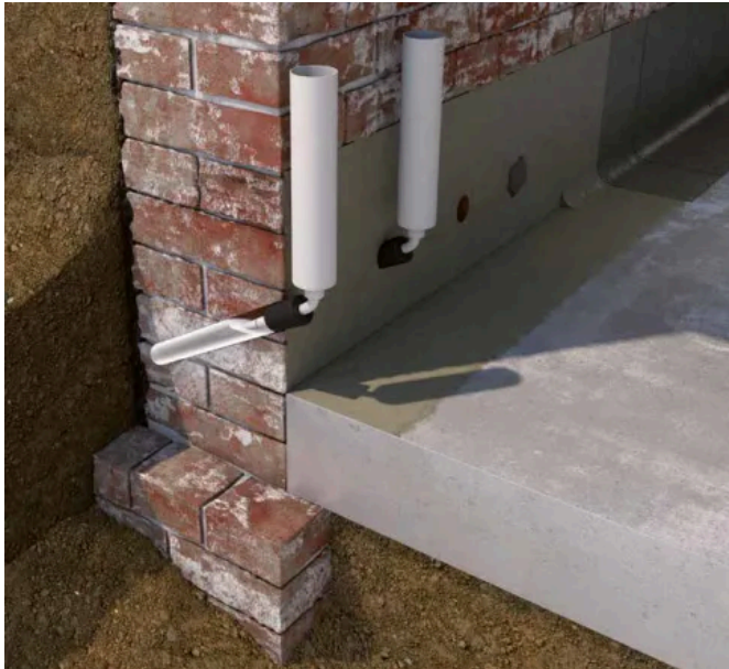
Das classic-Verfahren mit Bohrlochverschluss (© Remmers)
