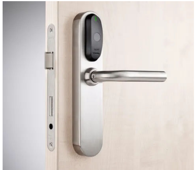
XS4 Original DIN-Beschlag kann auf Grund seiner Bauform und Montageart auch auf vorhandene Befestigungsbohrungen von Feuer- und Rauchschutztüren installiert werden.
