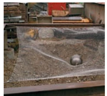
Testversuch zur Webnet Beanspruchbarkeit
