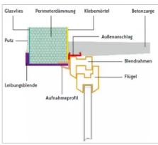
Passgenaue UNIfix KOMBI Leibungsblenden sind wärmegedämmt und schließen die Lücke im Wärmeschutz-Mantel des Hauses.
