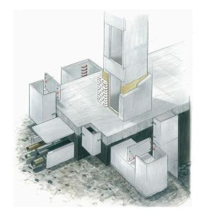
Maßgefertigte Betonfertigteilschächte als Lichtschächte, Lüftungsschächte, Aufzugschächte, Revisionsschächte, Versorgungsschächte, Ausstiegsschächte, Versorgungskanäle oder Kabelkanäle, mit diversen Abschlussprofilen für die Außenmontage an Keller- und Tiefgeschossen in verschiedenen Breiten, Schenkellängen, Bauhöhen und Wanddicken.
