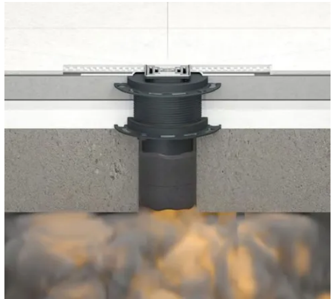
Die Deckendurchführung wird komplett verschlossen
