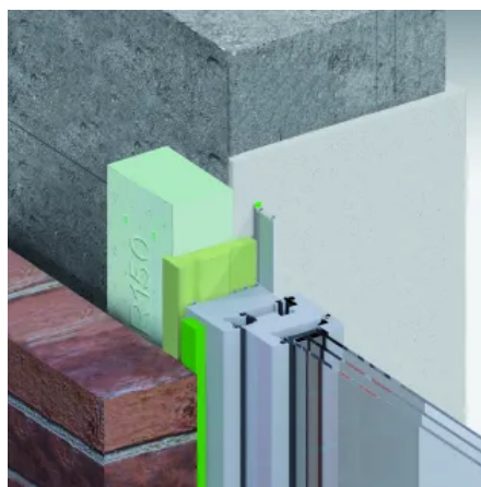
ProSystem Sanierung, Variante 7.5
