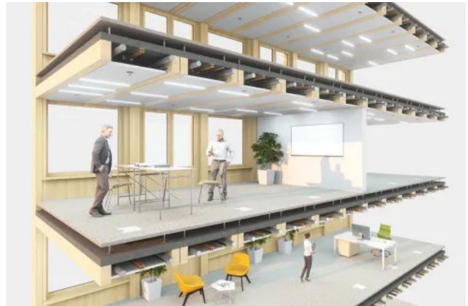
SupraFloor ecoboost 2 integriert eine Deckenklimatechnik in einem Holz-Beton-Deckensystem.
