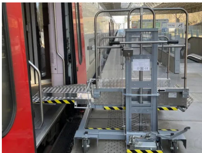
Die Rollstuhl-Hebebühne überwindet stufenlos Höhenunterschiede bis zu 1,10 m und kann bis zu 1,30 m ausgefahren werden.
