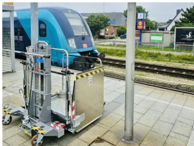
Hublift TAL-1100 zeichnet sich durch seine Mobilität aus, die einen barrierefreien Zugang an Bahnsteigen gewährleistet.
