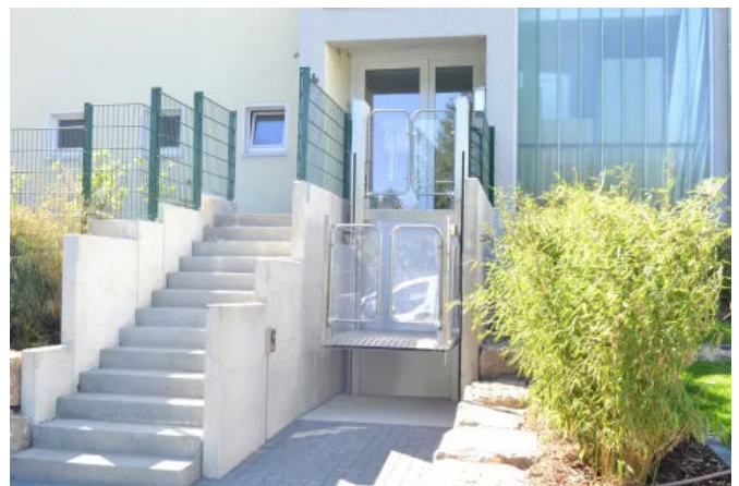
ATLAS 3000 fördert mit einem flüsterleisen Zahnriemenantrieb bis 3 m Höhe.
