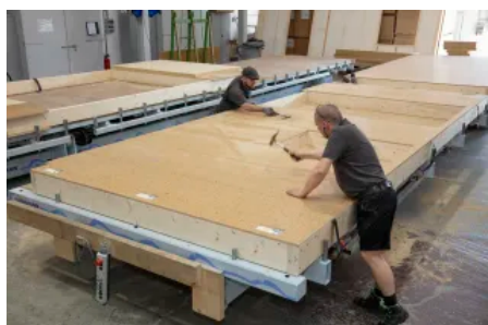
Produktion der L-systems- Holzrahmenbauelemente
