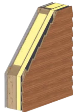
Modulkonstruktion mit vorgehängter Fassade
