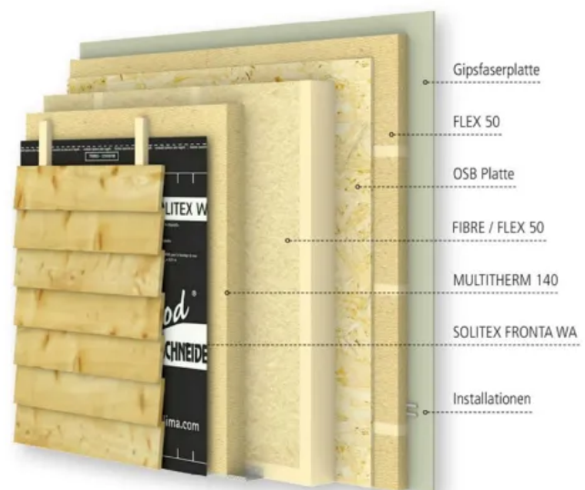
Außenwandkonstruktion mit best wood MULTITHERM 140 und best wood FLEX 50
