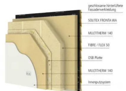
Wandkonstruktion mit best wood MULTITHERM 140, best wood FLEX 50 und verputzte Innendämmung best wood MULTITHERM 140
