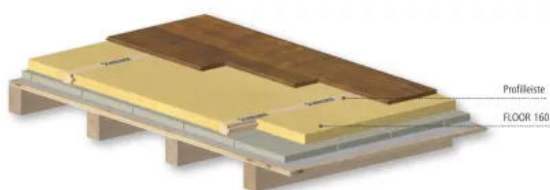
Bodendämmung mit best wood FLOOR 160 mit Einlegeleiste
