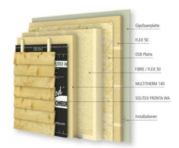
Wärmedämmverbundsystem mit best wood WALL 180 und best wood FLEX 50
