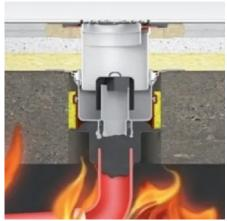
Im Brandfall expandiert die intumeszierende Masse verschließt sowohl die Deckenöffnung, als auch nicht brennbare Entwässerungsleitungen. Der Durchtritt von Wärme, Feuer und Rauch ist nicht mehr möglich.
