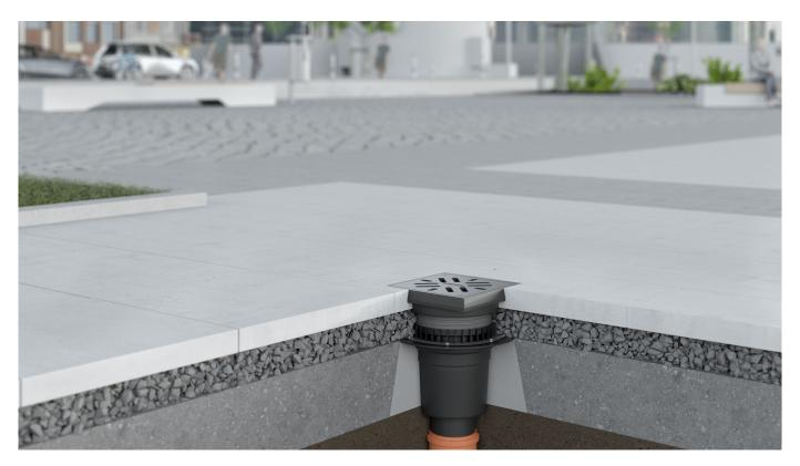
Dallmer Hofabläufe und Parkdeckabläufe bewähren sich in frostgefährdeten Außenbereichen und Verkehrsflächen. Mit dem Dallmer Brandschutz-Rohbauelement ist ein Einsatz in Gebäudebereichen mit erhöhten Brandschutzanforderungen, z.B. Tiefgaragen, möglich.
