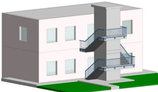
Aufzug frontal vorgesetzt mit Fluchttreppen
