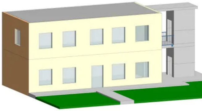
Aufzug seitlich angeordnet
