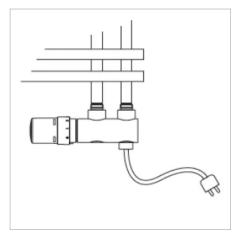
VHX-DUO mit Elektro-Heizstab, Heizleistung 150, 300 oder 600 Watt
