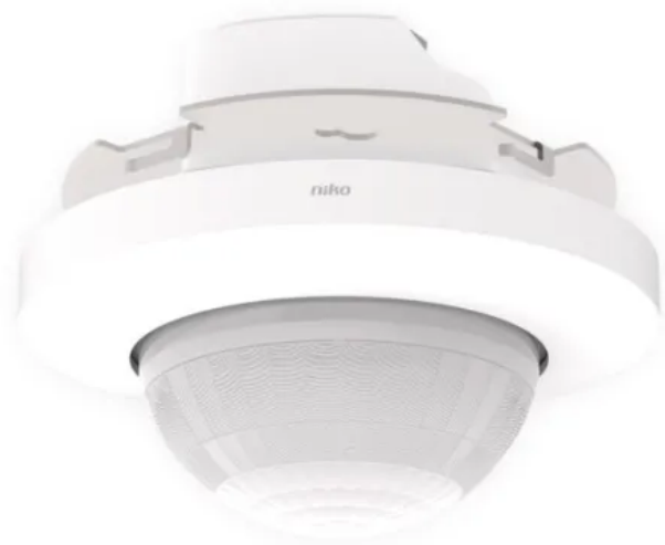
Präsenzmelder P42LR, 230 V, Master, 32-37 m, 360°, für Unterputzdose
