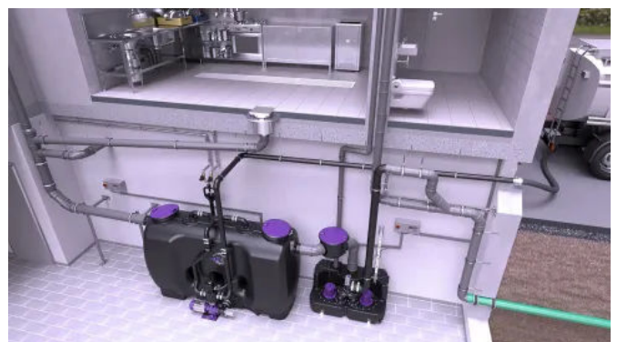
Hebeanlage Aqualift XL hinter einem Fettabscheider eingebaut
