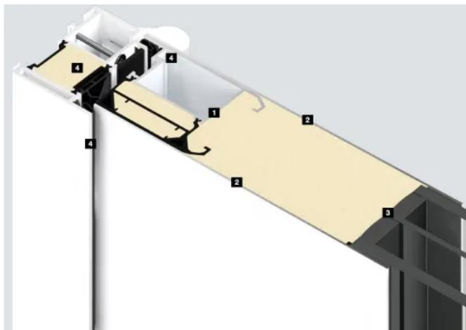
1. Bei ThermoSafe, ThermoSafe Hybrid, ThermoPlan Hybrid und ThermoCarbon Haustüren verbindet sich der PU-Schaum mit dem **Türprofil...**
