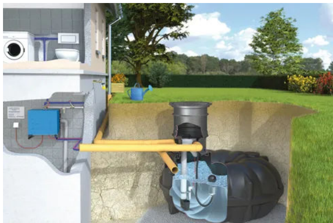
Haus-Komplettanlage NEO McRain mit Steuerungstechnik im Haus
