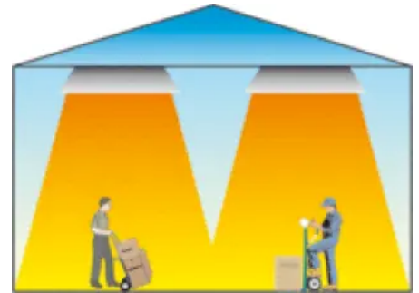
Dunkelstrahler erzeugen eine breite Wärmestrahlung.
