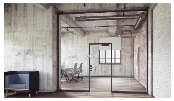
Das in Deutschland gefertigte System bietet flächenbündige Profile, Beschläge und Schließsysteme in einem einheitlichen Design. Die Aluminium-Profile sowie die sichtbaren Funktionselemente erhalten durch eine Pulverbeschichtung eine widerstandsfähige Oberfläche, die sich im Farbton passend zum Ambiente wählen lässt.
