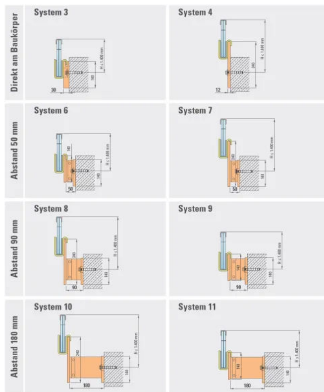
Anbindung an die Unterkonstruktion seitlich Abstand bis 180 mm
