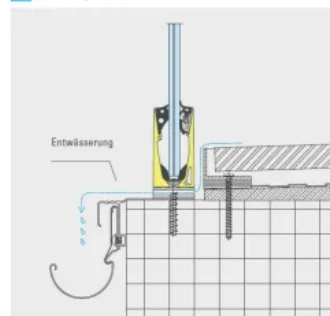
3 Anbindung von oben an Balkon
