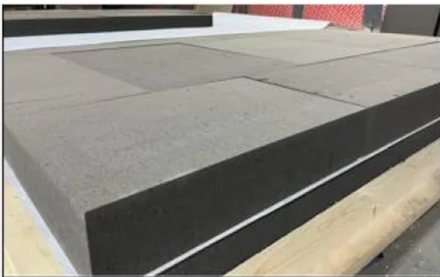
Lose verlegbare Schaumglasplatten auf Flachdach
